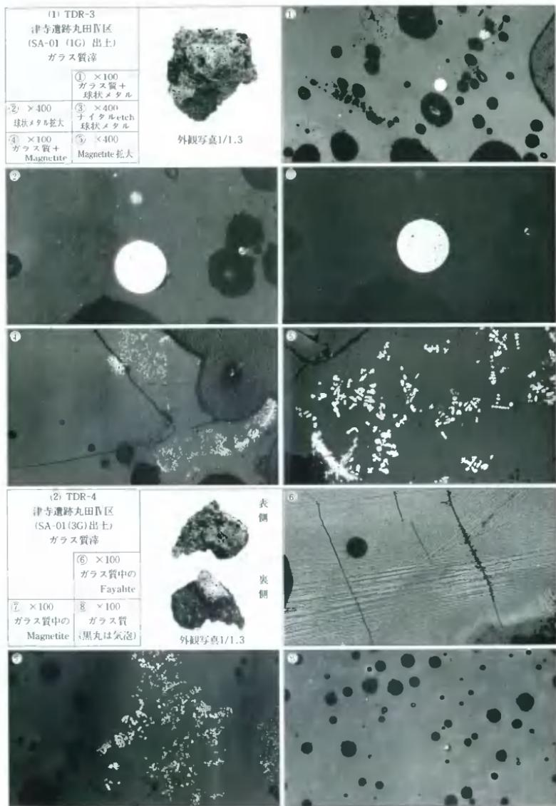
Photo. 1 ガラス質鐵滓の顕微鏡組織（縮小×0.8）
