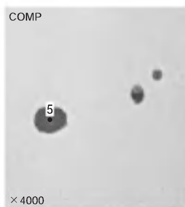
Photo. 2 鉄斧の非金属介在物のEPMA調査結果 母材(鉄)[左]と刃鉄(鋼)[右]
